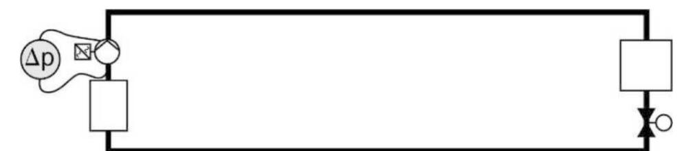
이런 순환 펌프 유형은 펌프 내의 파라미터를 측정하고 이에 따라 속도를 설정합니다. 설치 비용은 끝점 제어의 경우보다 저렴합니다. 그 이유는 외부  $\Delta p$  컨트롤러가 필요하지 않기 때문입니다. 펌프는 컨트롤 유형과 관계없이 일반적으로 동일합니다.
